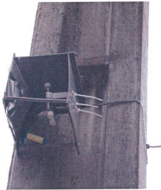
Photographies présentant les capteurs à échantillonnage passif utilisés lors des campagnes de mesures (Source : FSM).
