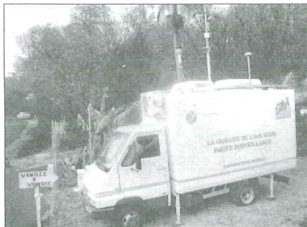
Au Tremblet, un des camions laboratoires de l'ORA analyse désormais en permanence la composition de l'air et l'acidité des pluies (photo F.M.-A.).
