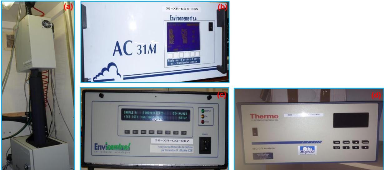
**Figure 4** : Photographies des analyseurs utilisés : TEOM-FDMS (a), AC31M (b), API 100 E (c) et THERMO 48c (d)
