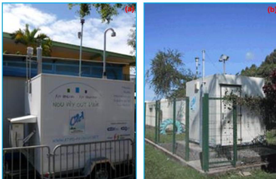
**Figure 2** : Remorque laboratoire installée sur la zone BER, école Antoine Bertin (a) et station fixe installée dans l'école La Marine (b) (**Source** : ORA).
