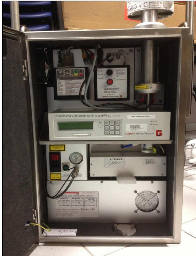
Figure 3 : Photographie de l'analyseur automatique GRIMM 365 (Source : ORA).
