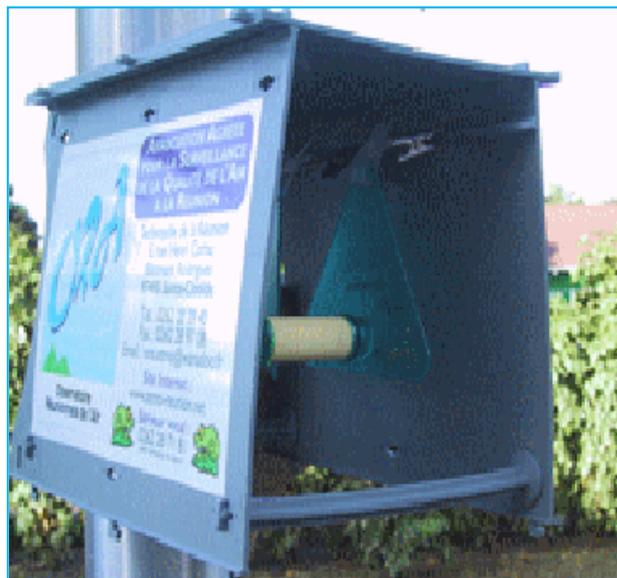
**Figure 3** : Abri comportant des tubes passifs installés sur un poteau (**Source** : ORA).
