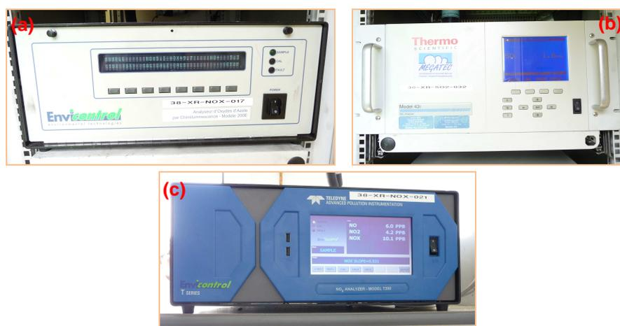
**Figure 3 :** Photographies des analyseurs utilisés : T200 NOx API (a), 43i Thermo E.I. (b) et 200E NOx API (c) (**source :** ORA).
