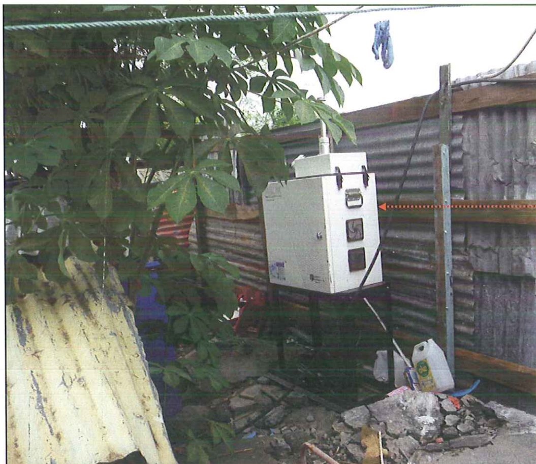
Photographie du Partisol en fonctionnement sur le site de mesure (Source : ORA).
