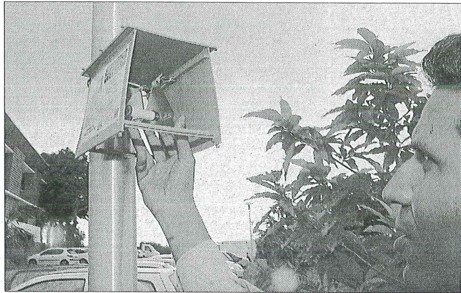
Le Dr Chatrapatty Bhugwant, chargé d'études à l'Observatoire réunionnais de l'air, avec l'une des stations permettant de mesurer la concentration en benzène (photo Stephan Lai-Yu).
