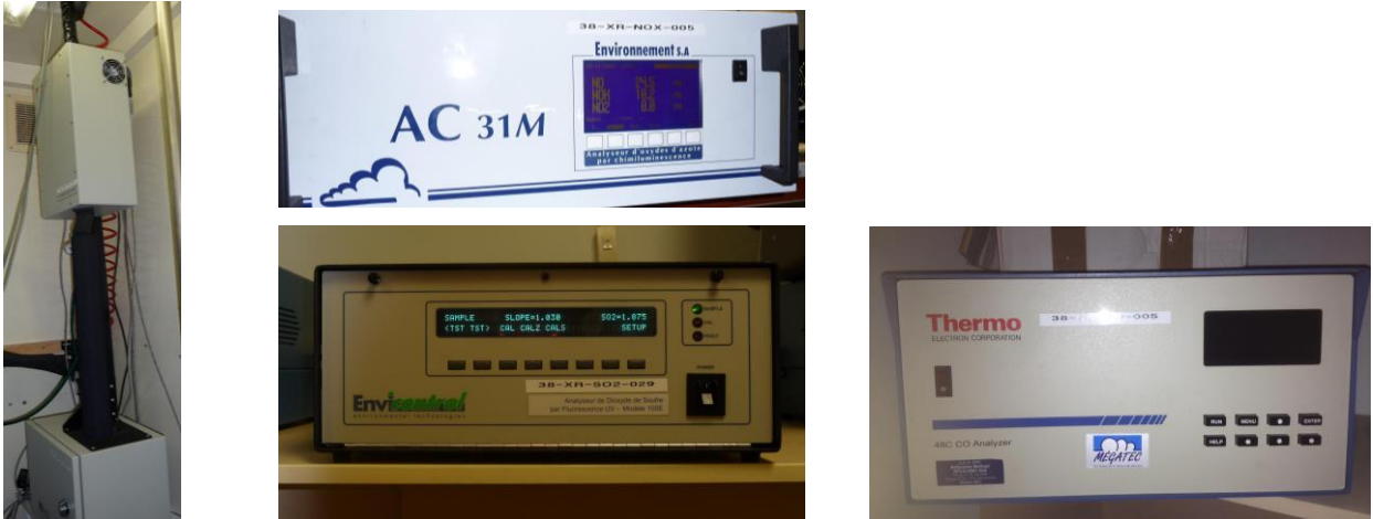
Figure 4 : Photographies des analyseurs utilisés : TEOM-FDMS à gauche, AC31M au centre en haut, API 100 E au centre en bas et THERMO 48c à droite ( Sources : ORA).
