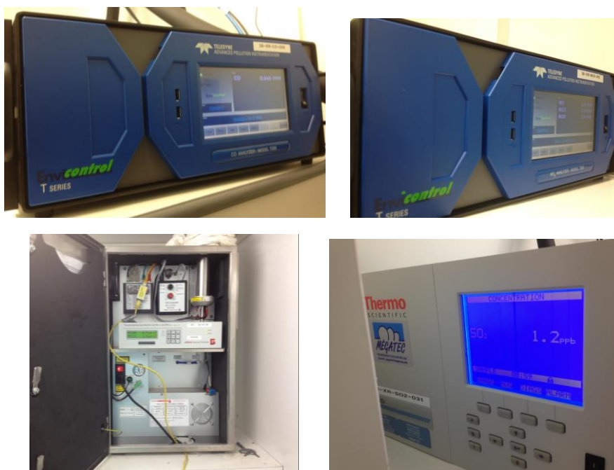
Figure 3 : Photographies des analyseurs utilisés : API T300 en haut à gauche, API T200 en haut à droite, GRIMM 365SVC en bas à gauche et à THERMO 43i en bas à droite ( Sources : ORA).
