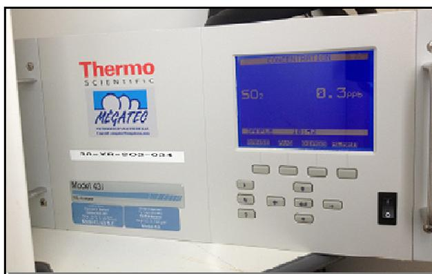
**Figure 3 :** Photographie de l'analyseur THERMO 43i (**Source :** ORA).
