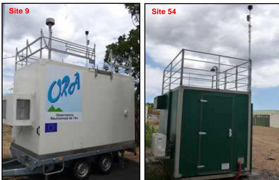
**Figure 2 :** Remorque laboratoire installée sur le site 9 : Maison de quartier et station fixe installée sur le site 54 : Centre pénitentiaire (**Source :** ORA).
