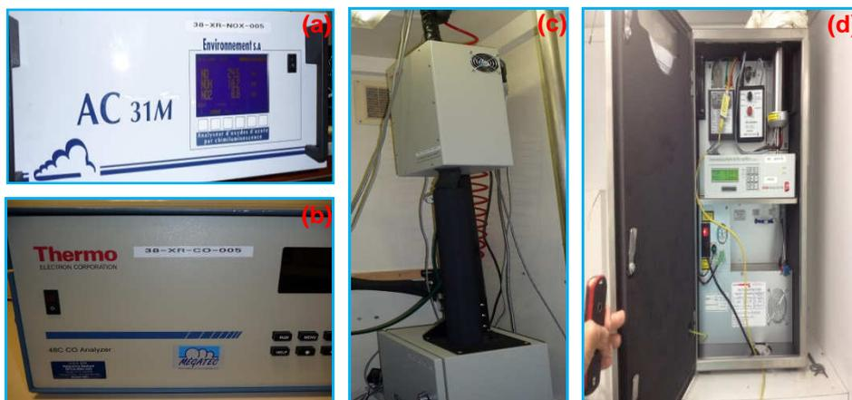
**Figure 3** : Photographies de certains analyseurs utilisés : AC31M (a), THERMO 48c (b), TEOM-FDMS (c) et GRIMM 365 SVC (d) (**source** : ORA).
