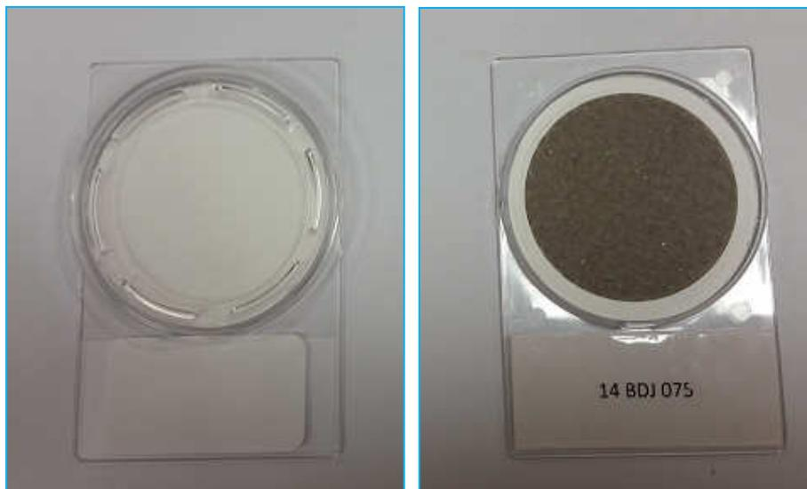
**Figure 14** : Filtre en fibres de quartz avant et après exposition de 24h sur la station BDJ (**Source** : ORA).
