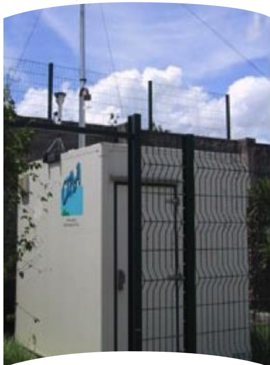
Figure 2 : Station de mesure de la qualité de l'air dans la Cité Scolaire du Butor à St Denis.
