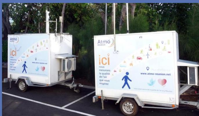
Le renforcement du dispositif de mesure fixe est réalisé par différents matériels de mesure mobiles et/ou de prélèvements (évaluation de la qualité de l'air dans des zones non surveillées, et/ou pour des études spécifiques) qui permettent une information locale complémentaire.
