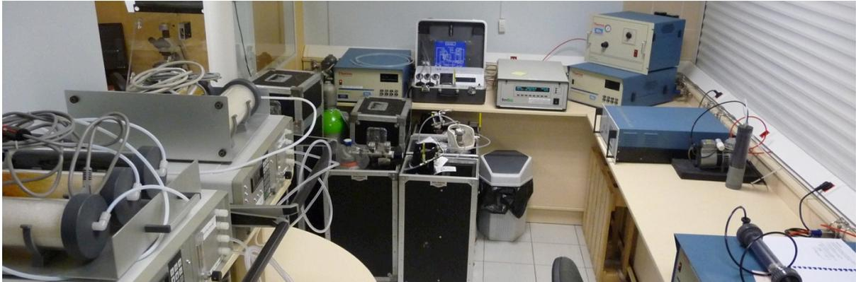
L'ensemble des mesures des polluants gazeux ( $\text{SO}_2$ ,  $\text{NO}_2$ ,  $\text{NO}$ ,  $\text{NO}_x$ ,  $\text{O}_3$ ,  $\text{CO}$ ) par analyseurs automatiques est raccordé grâce à la chaîne nationale d'étalonnage (voir ci-dessous).
