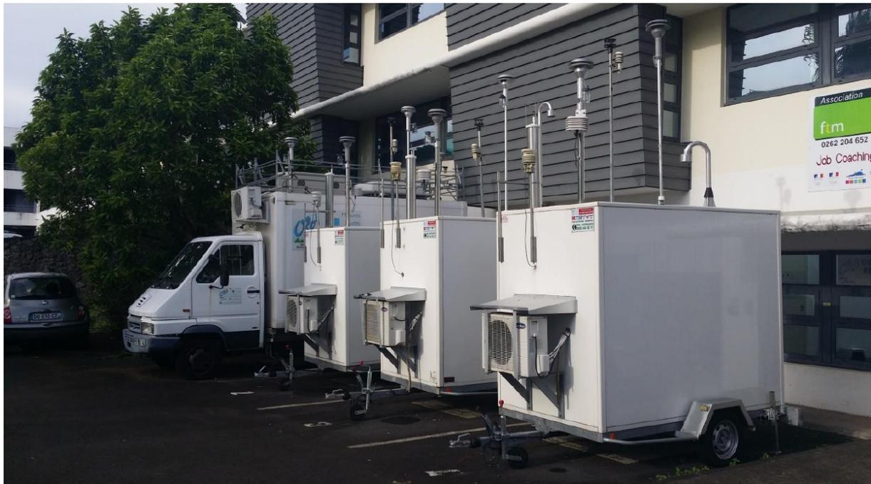
Le renforcement du dispositif de mesure fixe est réalisé par différents matériels de mesure et/ou de prélèvement (évaluation de la qualité de l'air dans des zones non surveillées, et/ou pour des études spécifiques) Il permet une information locale complémentaire. Utilisé dans le cadre de plans de surveillance industriels ou lors de mesures en milieu urbain ou rural, il permet la rédaction de documents d'expertise spécifiques.
