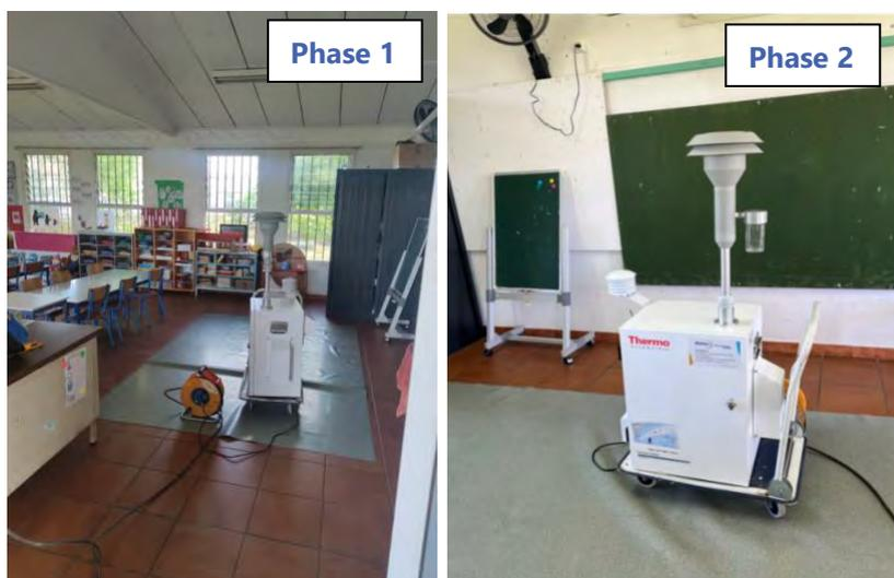
Figure 2 : Préleveur Atmo Réunion équipé de sa tête de prélèvement PM10 installé dans une salle de classe de l'école André HOAREAU (phase 1 et phase 2)
