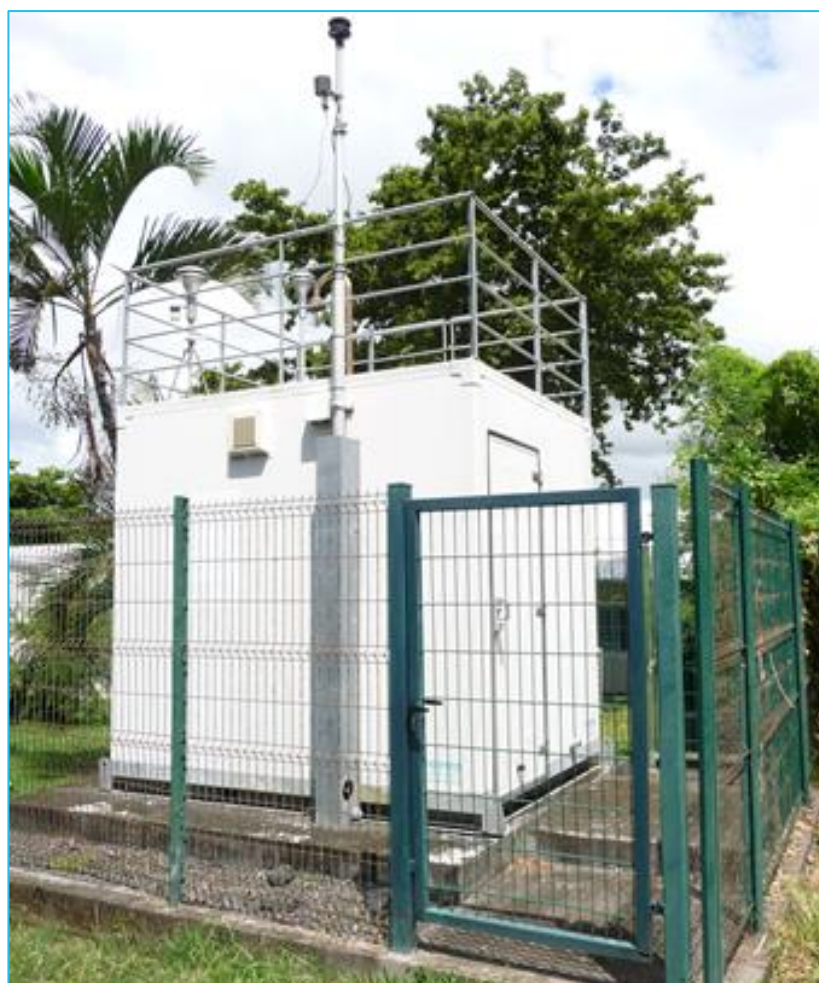
Figure 2 : Station fixe MAR implantée dans l'enceinte de l'école La Marine (MAR) à Sainte-Suzanne ( Crédit photo : ©Atmo Réunion).
