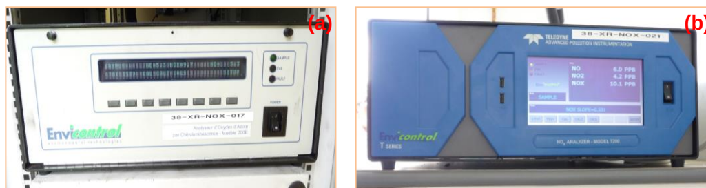
Figure 3: Photographies des analyseurs utilisés : (a) T200 NOx API et (b) 200E NOx API (Crédits photos : ©Atmo Réunion).
