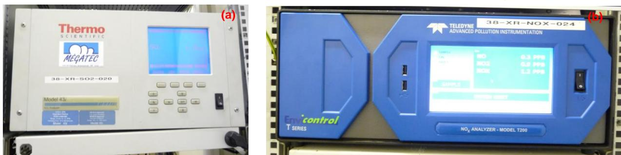
**Figure 3:** (a) Analyseur Thermo 43i SO<sub>2</sub> et (b) analyseur T200 NO<sub>2</sub> et NO<sub>x</sub> API (Crédits photos : ©Atmo Réunion).
