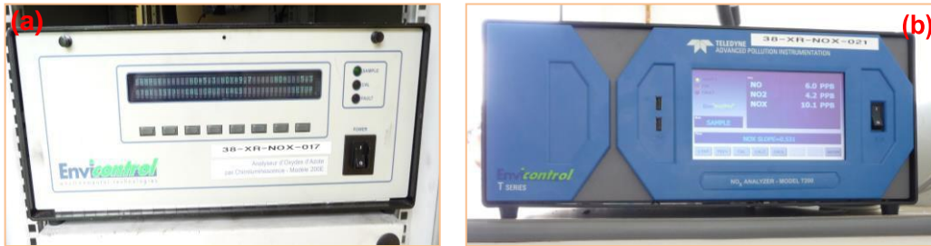
Figure 3: Analyseurs utilisés : (a) T200 NOx API et (b) 200E NOx API (Crédits photos : ©Atmo Réunion).
