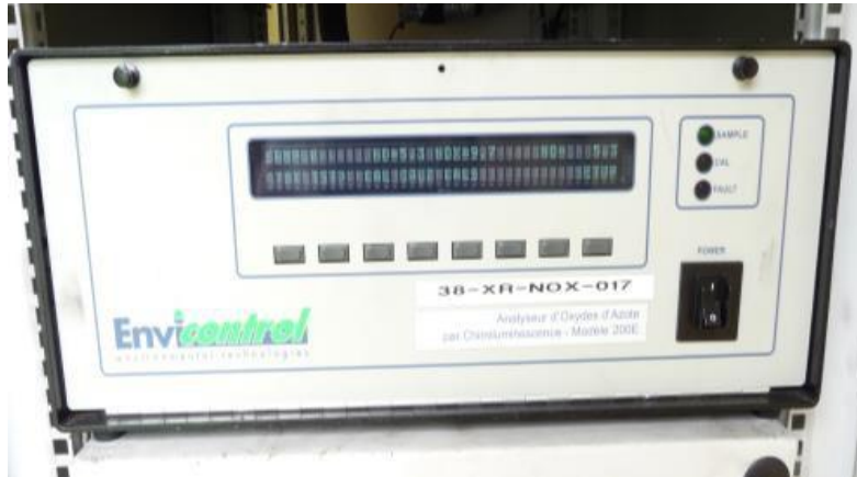
Figure 3 : Analyseur T200 NO x API implanté dans la station MAR ( Crédit photo : ©Atmo Réunion).
