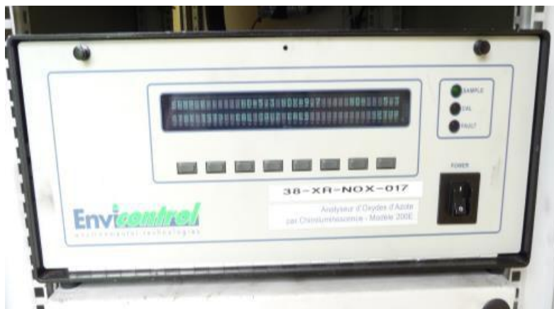
Figure 3 : Analyseur T200 NO x API implanté dans la station SG ( Crédit photo : ©Atmo Réunion).
