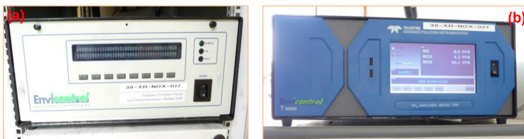
Figure 3: Analyseurs utilisés : (a) T200 NO x API et (b) 200E NO x API (Crédits photos : ©Atmo Réunion).
