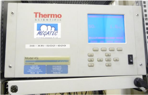
Figure n°3 : Analyseur Thermo 43i implanté dans la station fixe La Marine et dans la remorque laboratoire pour les sites mobiles Bertin, Bauhinias et Maya (Crédit photo : ©Atmo Réunion).
