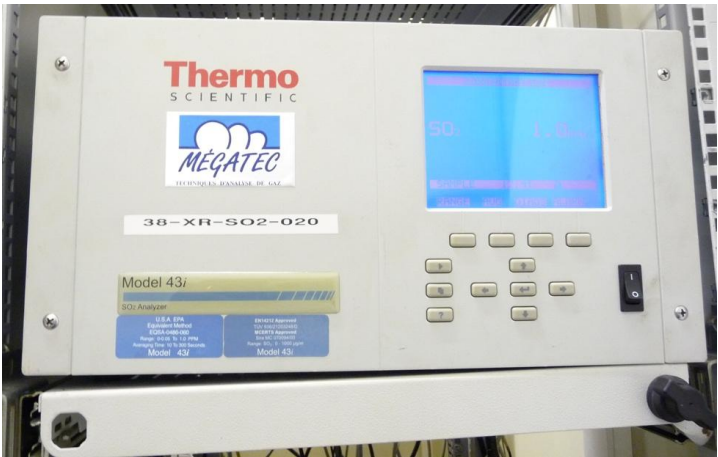
Figure n°3 : Analyseur Thermo 43i implanté dans la remorque laboratoire et la station Sarda Garriga (Crédit photo : ©Atmo Réunion).
