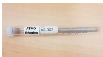
Figure 5: Tube à échantillonnage passif de C_6H_6 ( Crédit Photo : ©Atmo Réunion).
