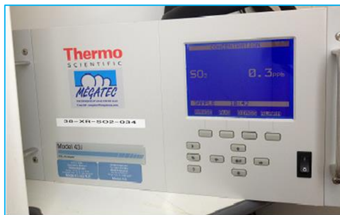
Figure 3 : Analyseur THERMO 43i installé dans les stations Terrain de Sel et Centre Pénitentiaire (Crédit photo : ©Atmo Réunion).
