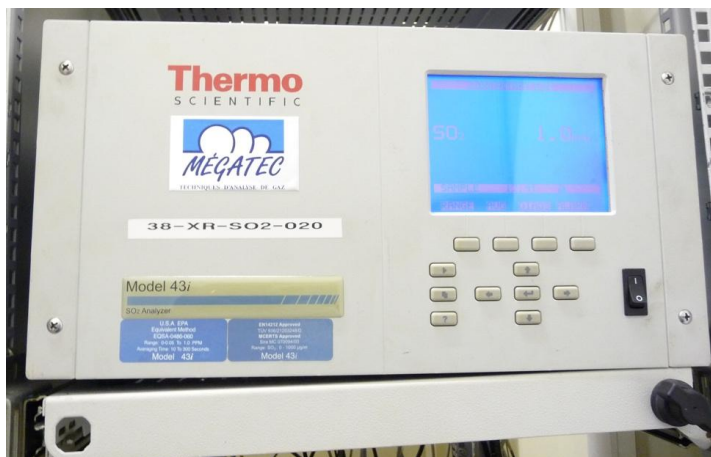
Figure 3 : Analyseur Thermo 43i implanté dans la station Sarda Garriga (Crédit photo : ©Atmo Réunion).
