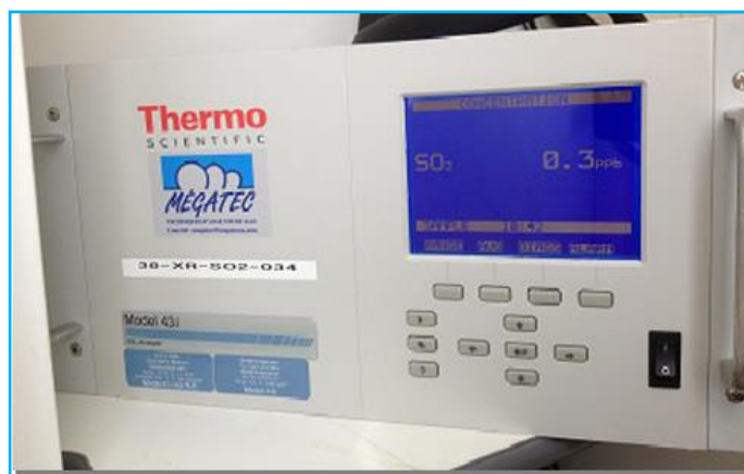
Figure 3: Analyseur THERMO 43i implanté dans les stations MQT et CPE (Crédit photo : ©Atmo Réunion).
