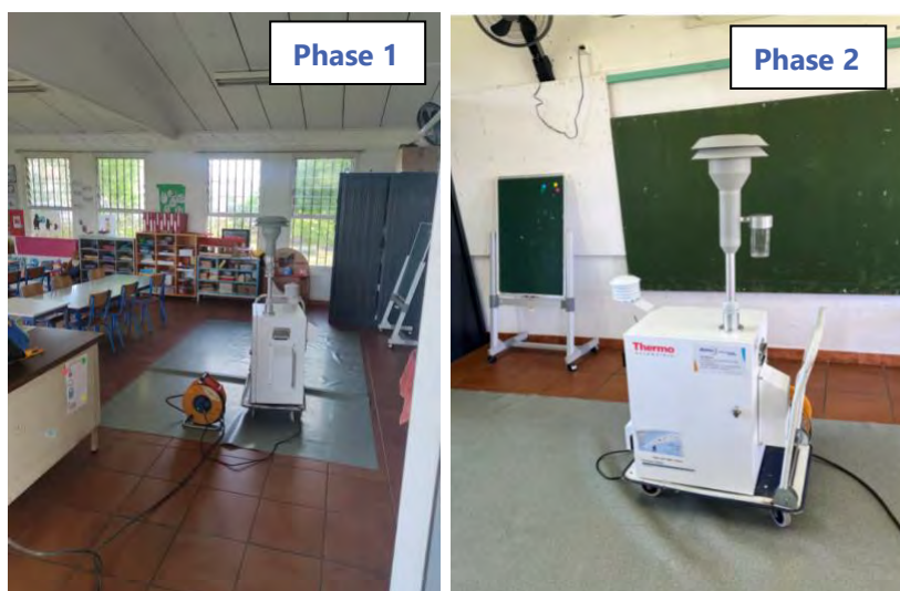
Figure 2 : Préleveur Atmo Réunion équipé de sa tête de prélèvement PM10 installé dans une salle de classe de l'école André HOAREAU (phase 1 et phase 2)
