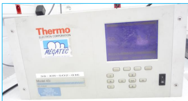
Figure 4 : Analyseur THERMO 43i installés dans les stations BMU et GCO ( Source : ORA).
