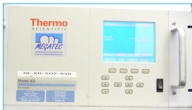
Figure 4 : Analyseur THERMO 43i installés dans les stations BMU et GCO ( Source : ORA).
